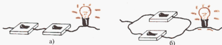
Рис. 41. Последовательное (а) и параллельное (б) соединение переключателей
