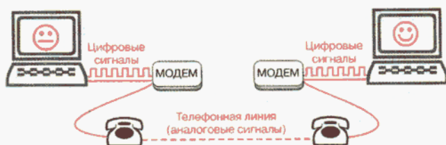
Рис. 15. Схема связи двух компьютеров по телефонной линии
